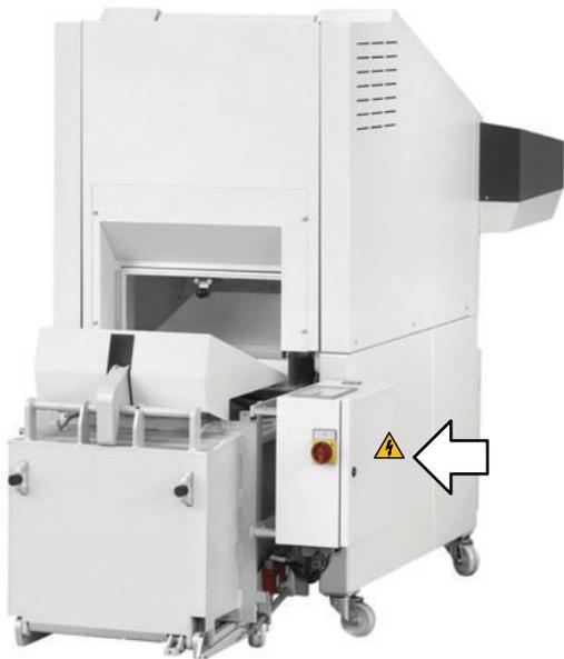
1. Todas as chapas de proteção têm de estar montadas e aparafusadas com firmeza. (ver imagem)
