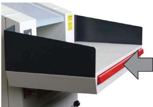
4. Se pressionar a régua de comutação de paragem de emergência, com a máquina em funcionamento, a destruidora e a prensa de enfardar devem parar imediatamente. As máquinas só podem ser novamente ligadas depois de a régua de comutação ter sido puxada para fora.
